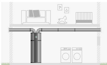
Brauchwarmwasserbereitung im Außenluftbetrieb
