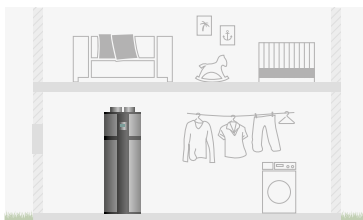
Brauchwarmwasserbereitung, Raumkühlung und Entfeuchtung im Umluftbetrieb
